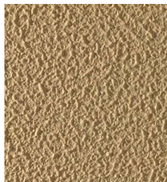
10. kép. hengerelt vékonyvakolat szivacs hengerrel
