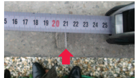
6. kép. A ~10 mm vastag kéregből legfeljebb 1-1,5 mm a hálóbeágyazás, míg ~7 mm a felületkiegyenlítés.
