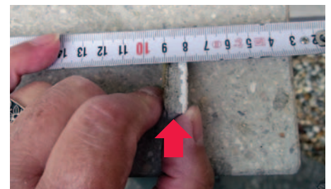
8. kép. A ~10 mm vastag kéregből legfeljebb 1-1,5 mm a hálóbeágyazás, míg ~6 mm a felületkiegyenlítés! Figyelem: a fehér vékonyvakolat anyaga belenyomódott a kiegyenlítő ragasztó rétegbe, azaz a ragasztó olyan képlékeny volt vakoláskor, hogy kitért a vékonyvakolat szemcséi elől, illetve a glettelés okozta erőbehatásoktól.
